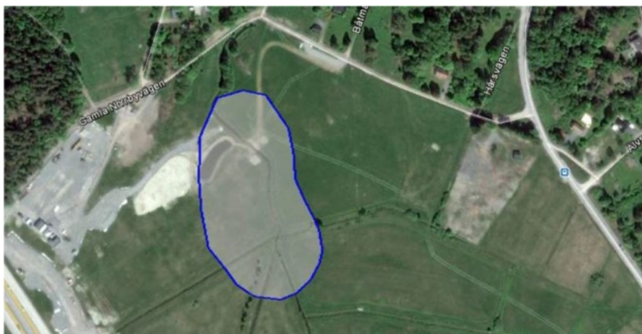
Figur 3. Illustration av ytbehov och ungefärlig placering av en dagvattendamm vid Norrby gärde. Ytan på 1,9 hektar (våtyta) motsvarar cirka 1 % av avrinningsområdets reducerade yta.
