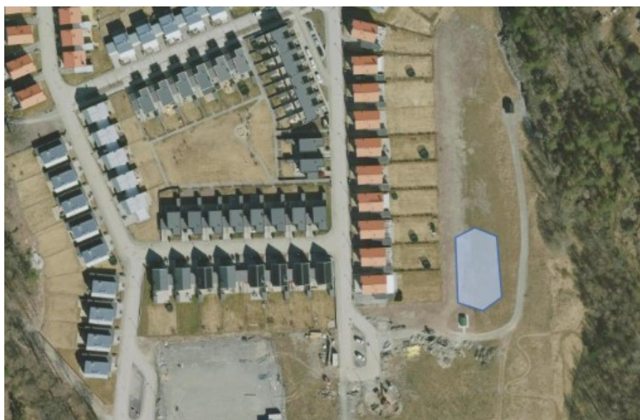
Figur 21. Illustration av ytbehov och möjlig placering av en dagvattendamm på 0,06 hektar (våtyta), vilket motsvarar cirka 1 % av avrinningsområdets reducerade yta.
